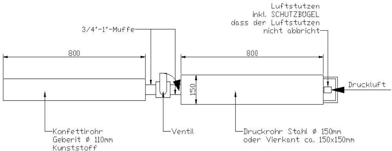
Für die Druckluft verwendet Ihr grosse Druckluftflaschen, wie sie zum Schweißen gebraucht werden und füllt mit einem Spiralschlauch dann die Kanone.
